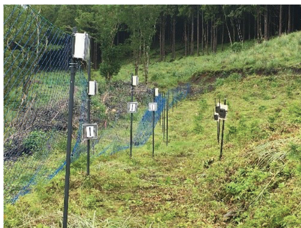
図5-3 加速度センサーとカメラの配置状況
