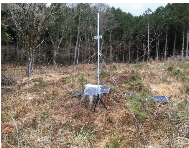
図 4-13 ゲートウェイ装置のアンテナの高所化
