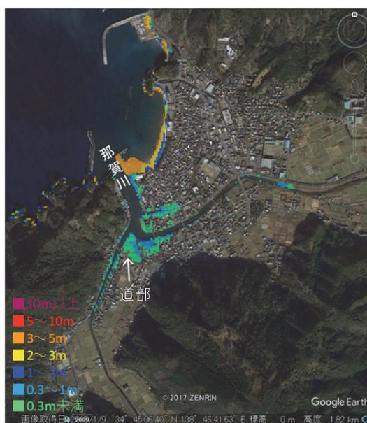
図4 断層のすべり量3.64mのケースでの浸水範囲（水門未整備）
