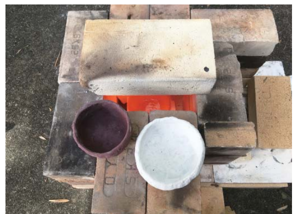
図6 耐火煉瓦による簡易的なガス窯
