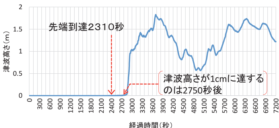
図13 今切口を広げた状態でひずみ1000年蓄積を想定したシミュレーション
