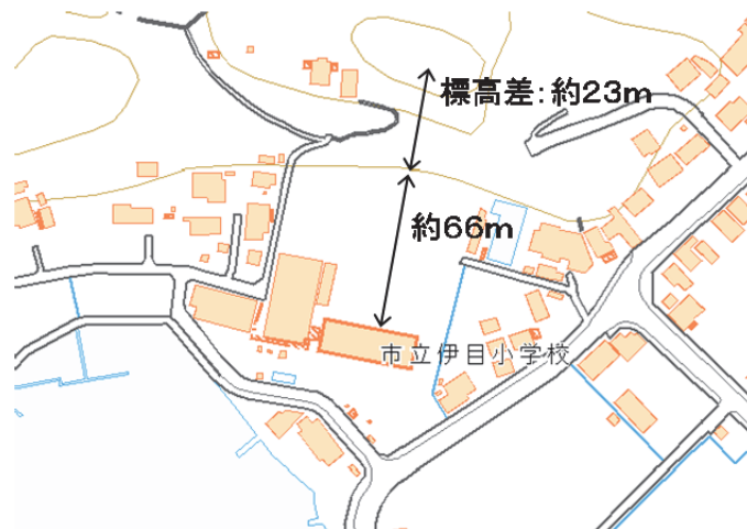
図4 伊目小学校と急傾斜崩壊危険地までの距離
